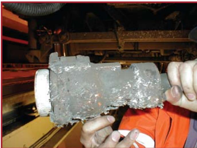
**Connettori e cavi affrontano condizioni ambientali aggressive nelle applicazioni ferroviarie. Prodotti non adeguatamente sigillati o realizzati con materiali scadenti possono portare ad errori nel sistema.**
