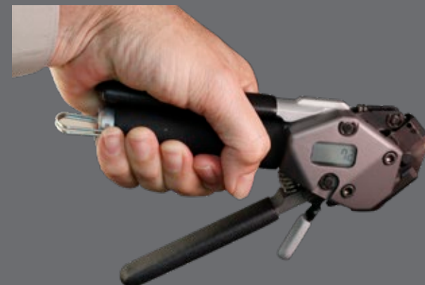
כלים ידניים קלים ונוחים לשימוש עם מונה לחיצות מובנה לכיול מדויק
