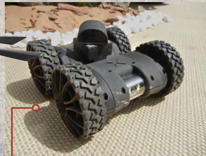
Le petit robot Nerva de Nexter est conçu pour évoluer en tout-terrain et sous conditions climatiques difficiles, à la vitesse d'un fantassin au pas de course.
